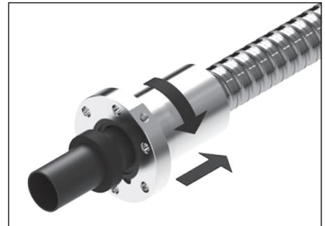
Die Montagehülse erst entfernen, wenn sich die Muttereinheit vollständig auf dem Spindelgewinde befindet.
