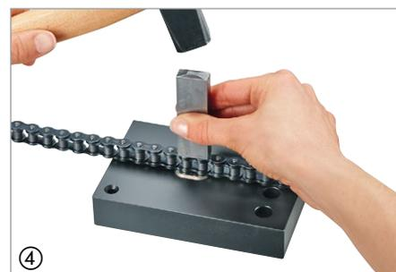
Der Laschendrucker wird über den Nietkopf gesetzt und die Lasche wird so weit nachgeschlagen, dass die Kettenglieder immer noch leicht beweglich sind ④.
