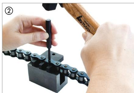
Die Kette wird bis zum Anschlag der beiden benachbarten Rollen in die Gabel geschoben. Dann legt man die Gabel mit der Kette auf den Amboss und schlägt die Bolzen mit einem Hammer so weit hinein, bis sie nicht mehr überstehen. Mit dem Durchschlag (B) werden nun die Bolzen ganz hinausgeschlagen ②. Mehrfachketten werden auf die gleiche Art zerlegt, jedoch ist zu beachten, dass die Gabel in den unteren Kettenstrang eingeschoben wird.
