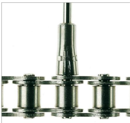
Der Adapter wird mit der Aufnahme ① gefasst und durch Schließen des Werkzeuges gesprengt. Vorgang ggf. mit 45° Positionsänderung wiederholen. Der Adapter ist zerstört, und der Stift kann problemlos entfernt werden.
