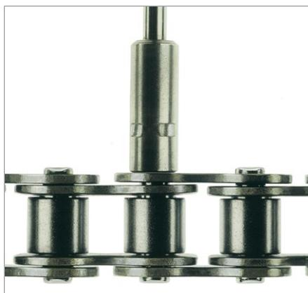
Der neue Adapterstift wird auf den verlängerten Kettenbolzen aufgesetzt. Mit der Aufnahme ② wird er gefasst und durch Schließen des Werkzeuges befestigt. Die Kette ist repariert und somit wieder voll funktionsfähig.
