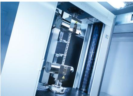
Bruchkraftermittlung und Dehnungsaufnahmen bis 1000 kN
