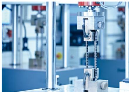
Dauerfestigkeits- und Zeitfestigkeitsüberprüfungen durch mehr als 25 Pulsatoren nach unterschiedlichen Prüfungsverfahren
