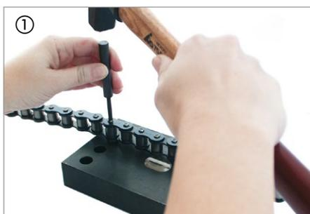
Man steckt den vorstehenden Bolzen in die entsprechende Büchse der Nietplatte und schlägt ihn mit dem Hammer so weit hinein, bis er nicht mehr übersteht. Mit einem Durchschlag wird dann der Bolzen ganz ausgeschlagen ①.
