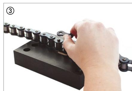
Die Verfahrensweise ist bei Ketten mit abgesetzten Bolzen die gleiche, wie bei Ketten mit glatten Bolzen. Man steckt einen neuen Stiftblock in die zwei Kettenenden, legt die Kette auf das Einsatzstück der Nietplatte und drückt eine neue Außenlasche auf die Nietenden des Stiftblocks ③.
