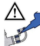
4. Schmierstelle mit allen Anschlussteilen und Schlauchleitungen vorschmieren. Alle Anbauteile und Schläuche müssen vorgefüllt werden, damit der Schmierstoff sofort die Schmierstelle erreicht.
