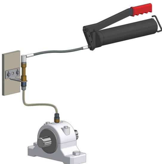
6. Verwenden Sie zum Vorschmieren und Befüllen der Schlauchleitungen einen Schlauchvorfülladapter.
