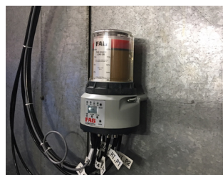
CONCEPT8 sorgt für eine punktgenaue Schmierung der Lager.
